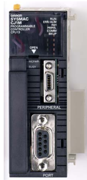
CJ1-type PLS med ny Peripheral Port øverst og Host Link Port (D-Sub, 9 pin) port nederst.
